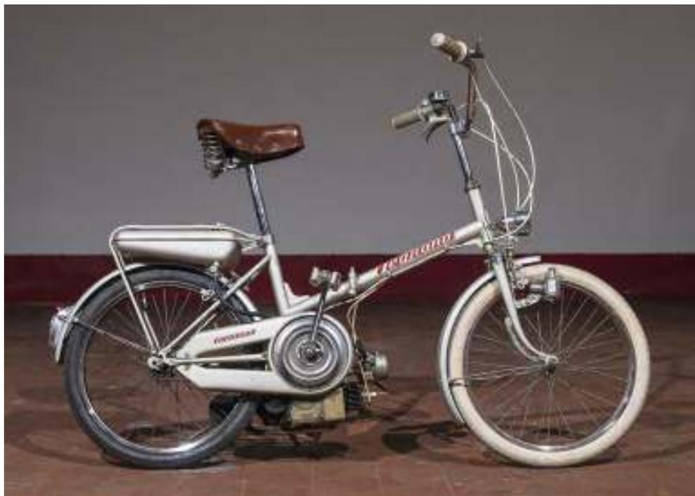
Bici pieghevole della Legnano color beige con sella extra-large per un utilizzo cittadino. Motorizzata, questa bici è un interessante esempio di razionalizzazione degli spazi, con tanto di serbatoio del carburante posto sotto il portapacchi posteriore
