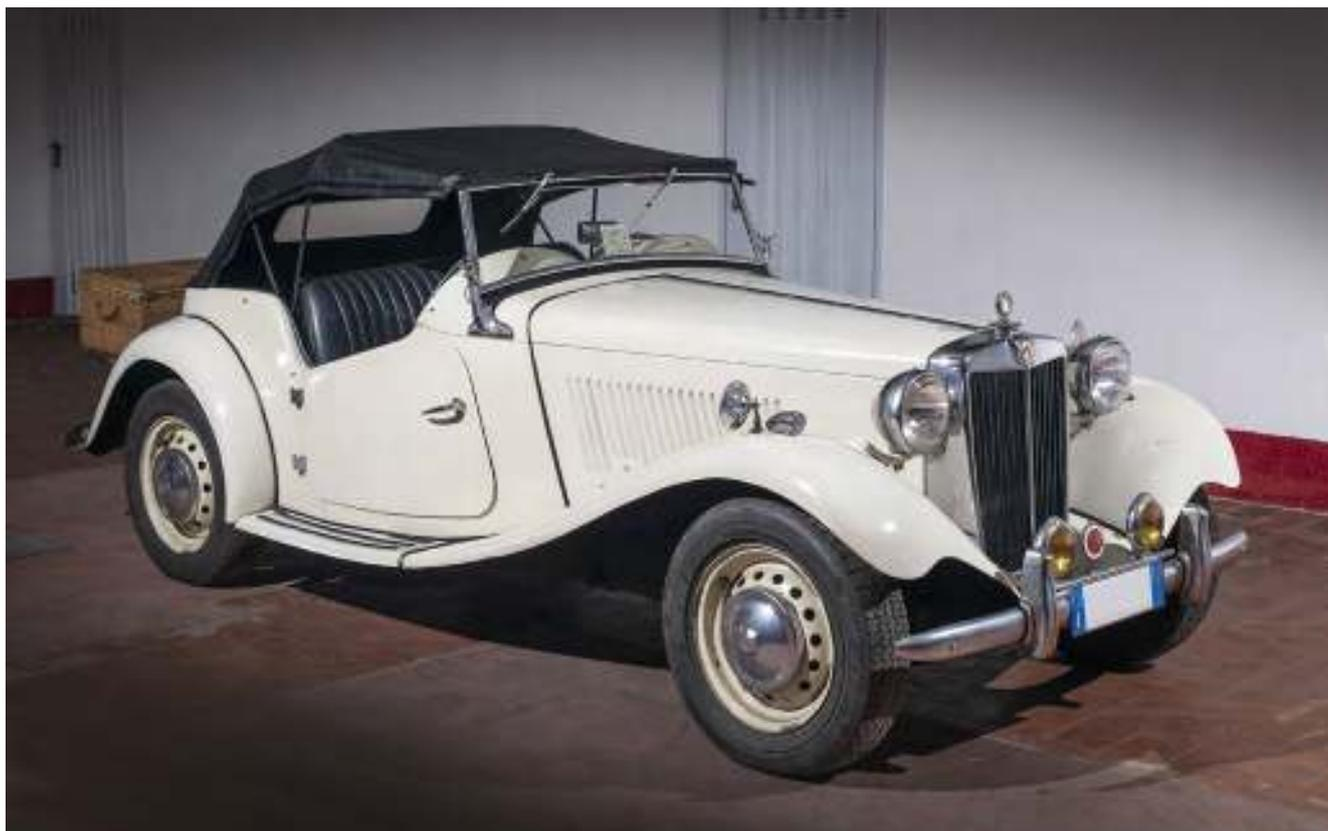
Nel 1950, MG annunciò la produzione del TD. Costruita sul telaio della berlina Y-Type, presentava la precedente trasmissione della serie TC con un assale posteriore ipoide modificato, sterzo a pignone e cremagliera e la disponibilità della guida a sinistra. La produzione di TD cessò nel 1953, quando MG fece debuttare la sua sostituta, la TF. Probabilmente una delle auto di maggior successo dei veicoli MG, la serie T fu prodotta dal 1936 al 1955.
